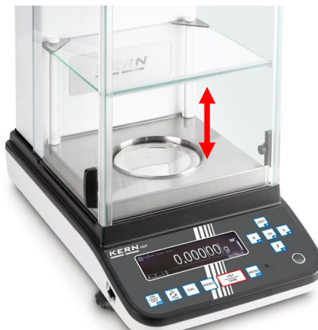
Fig. 2: Protezione antivento interna con staffe corte e protezione in stagno
