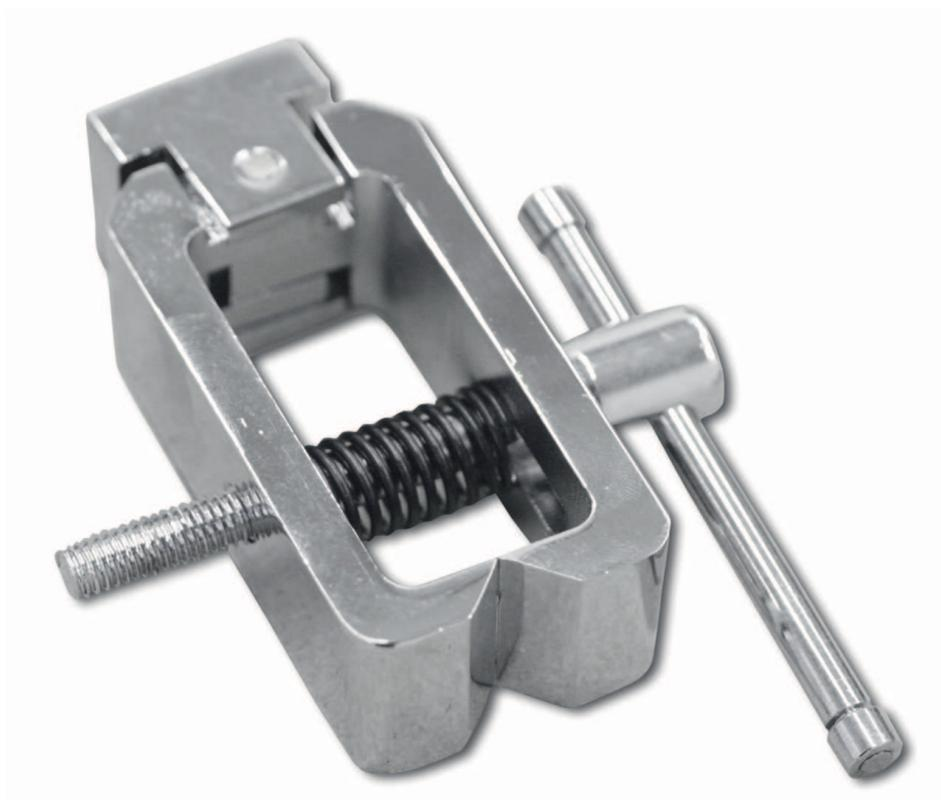
Morsetto a vite per prove di trazione e di strappo
