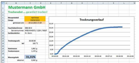
Protocole de mesure avec diagramme montrant l'évolution d'une mesure de l'humidité
