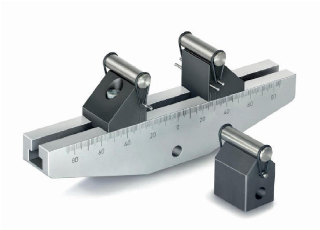
Dispositivo de flexión solo para dinamómetros hasta máx. = 10 kN
