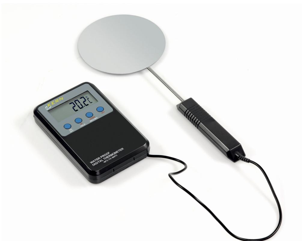
Set calibrazione temperatura composto da indicatore e sensore
