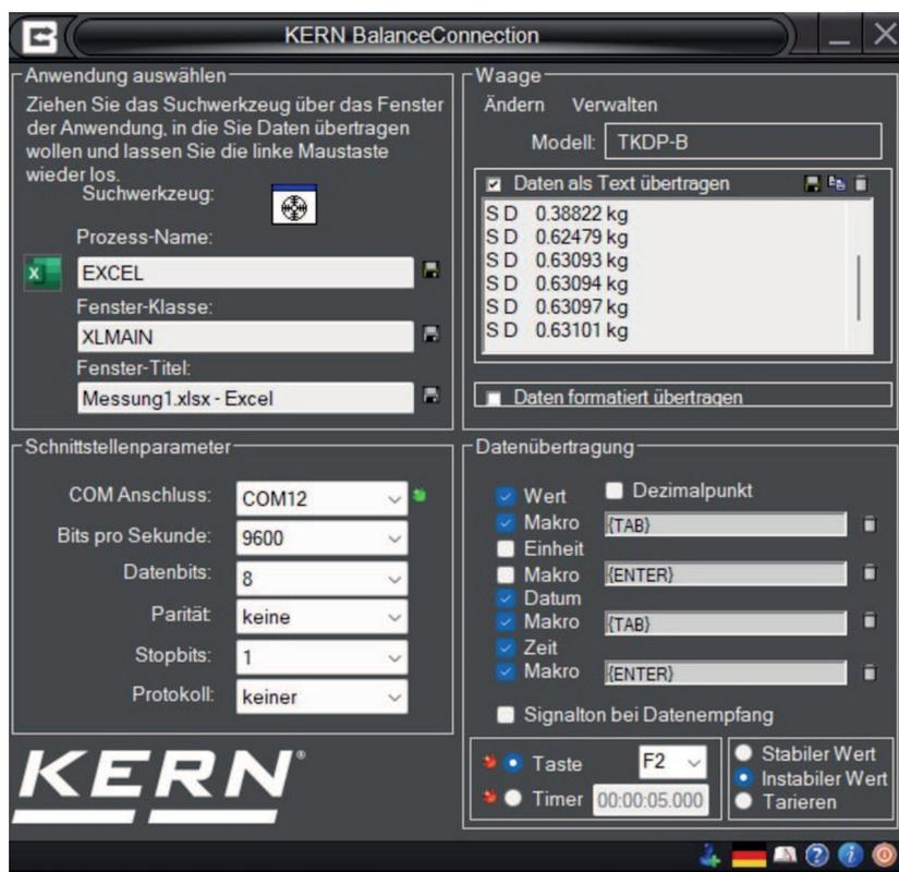
Registrazione o trasmissione flessibile dei valori di misurazione, in particolare anche con Microsoft® Excel o Access
