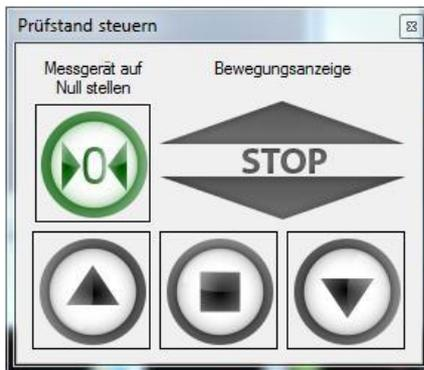
Der Dialog enthält drei Knöpfe zur Steuerung der Bewegung des Prüfstands, einer um das Kraftmessgerät auf null zu stellen und eine Anzeige, die die aktuelle Bewegungsrichtung des Prüfstands anzeigt.
