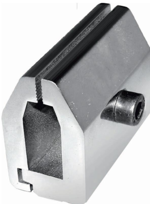
Morsetto a vite per prove di trazione
