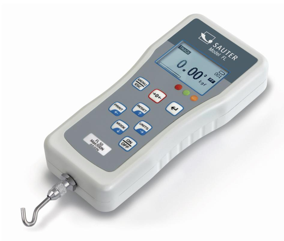
Strumento di misurazione per forze universale e digitale con display supportato da grafica e cella di misura integrata
