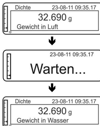
⇒ Warten, bis die Anzeige zur Gewichtsbestimmung des „Senkkörpers in der Prüf-
