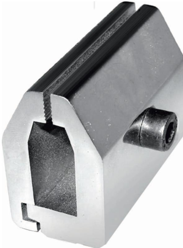
Schraubspannklemme für Zugtests
