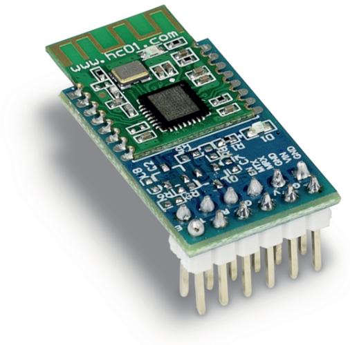
Bluetooth-Datenschnittstelle zur kabellosen Datenübertragung an PC oder Tablets
