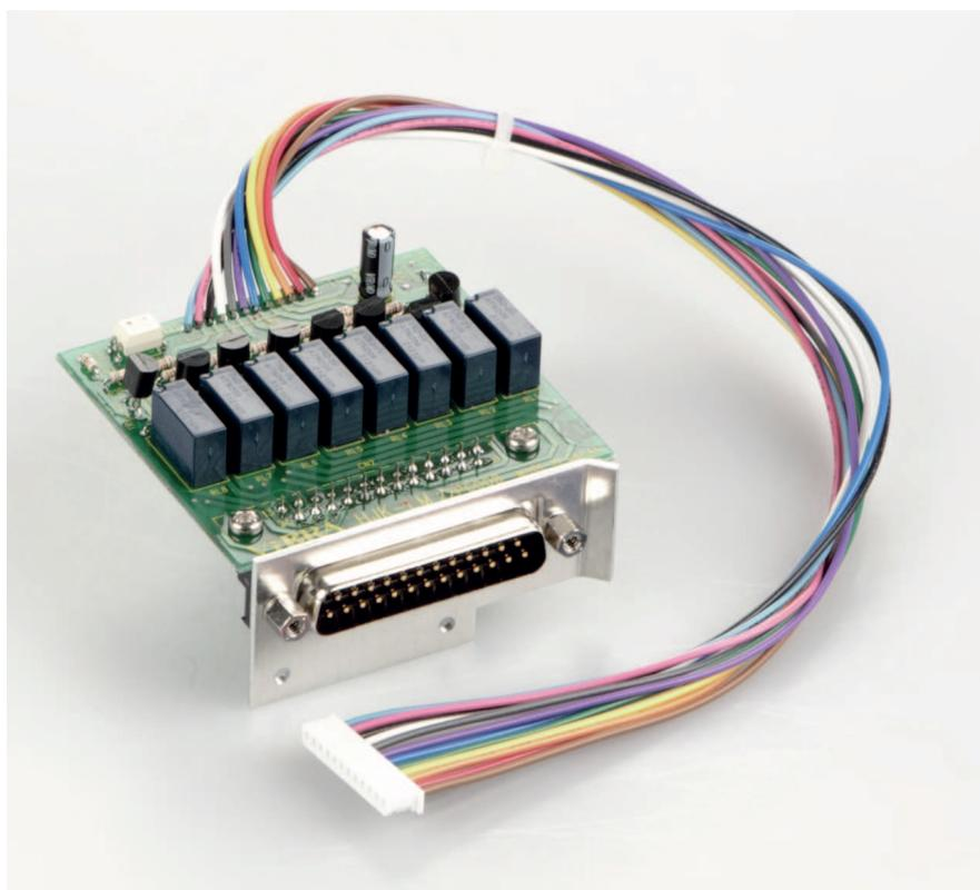
Sortie relais pour raccorder des relais, voyants signalétiques, valves etc., 5 sorties pour peser dans 3 plages de tolérance, ne peut pas être équipé ultérieurement
