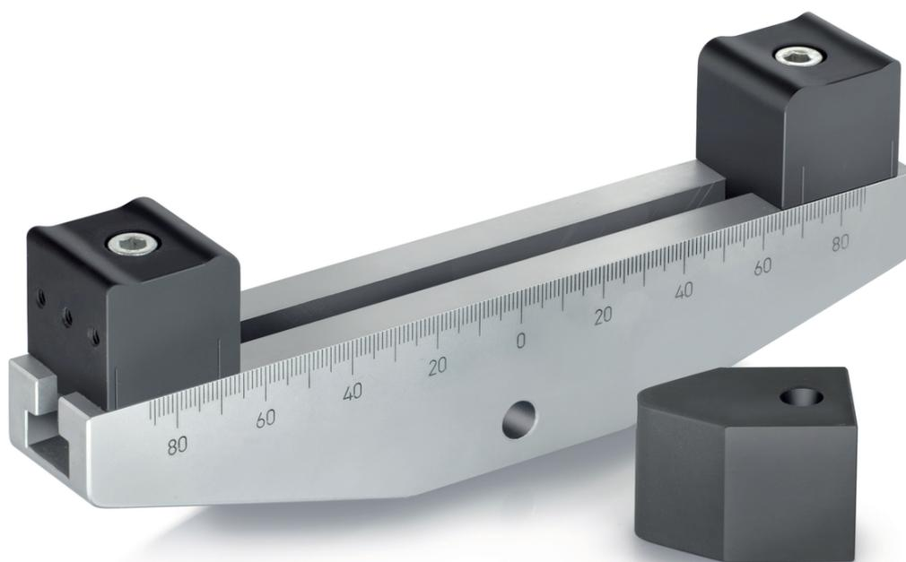
Cintreuse uniquement pour les dynamomètres jusqu'à max. = 10 kN
