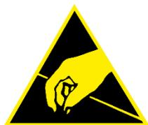
L'unità può essere distrutta da scariche elettrostatiche. I connettori per i segnali HF sono particolarmente a rischio. Si prega di osservare le istruzioni per la manipolazione dei componenti sensibili alle cariche elettrostatiche.
