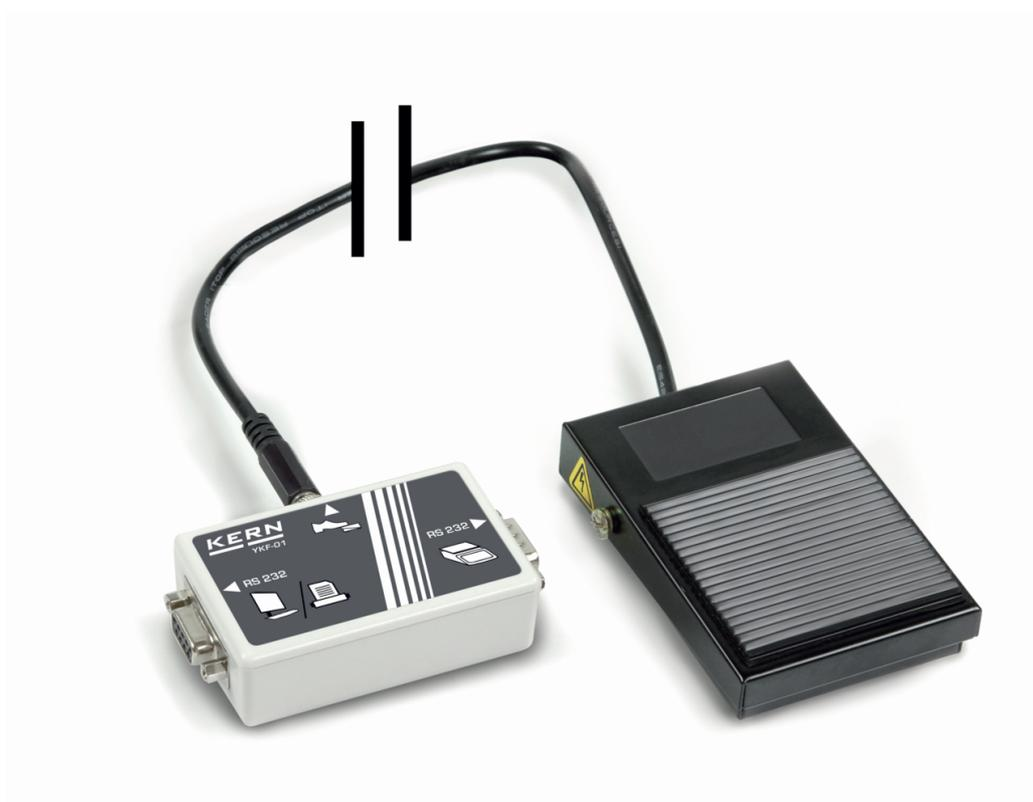
Interruptor de pie, ideal cuando la aplicación requiere tener las manos libres. Control de la función TARE o imprimir PRINT. Alcance de suministro: Interruptor de pie, caja de conexiones, cable de conexión. Para la función PRINT se necesita el cable de interfaz RS-232
