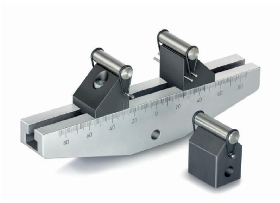
Cintreuse uniquement pour les dynamomètres jusqu'à max. = 10 kN
