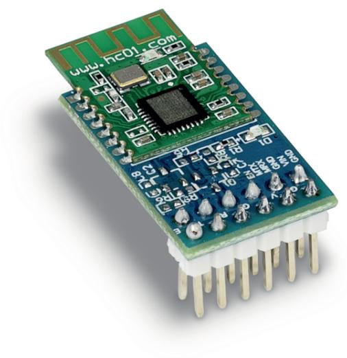
Interfaccia dati Bluetooth per la trasmissione wireless di dati su PC o tablet
