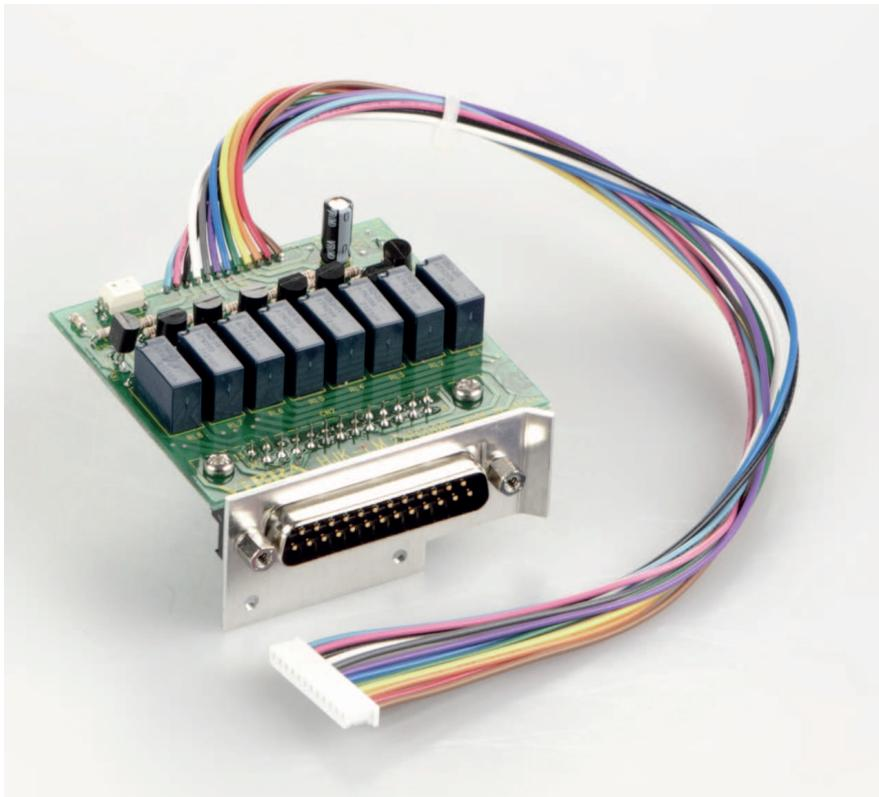
Relais-Ausgang zum Anschluss von Relais, Signallampen, Ventilen etc., 5 Ausgänge für Wägungen in 3 Toleranzbereichen, nicht nachrüstbar
