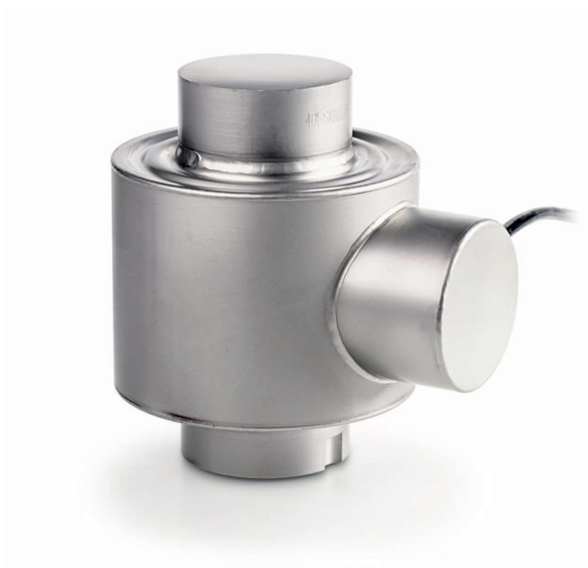
Dynamomètre en acier inoxydable
