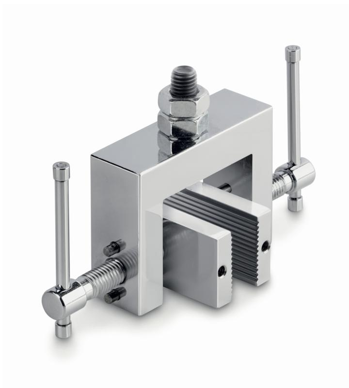
Morsetto a vite con presa larga per prove trazione e estrazione
