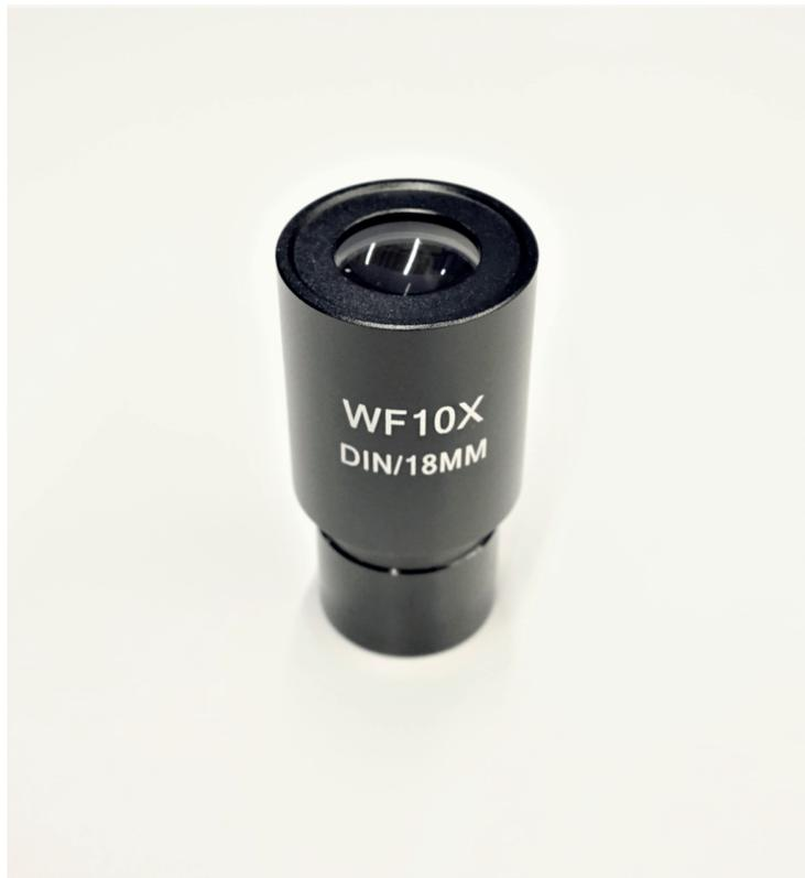
Ocular: WF 10 x / Ø 18 mm (con escala 0,1 mm)
