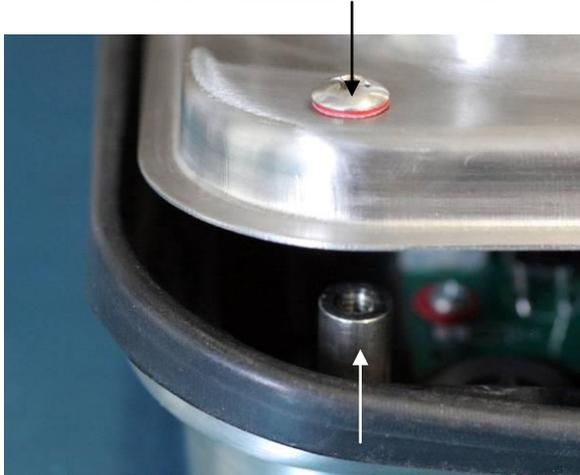
Reserrer les vis sur le côté arrière
