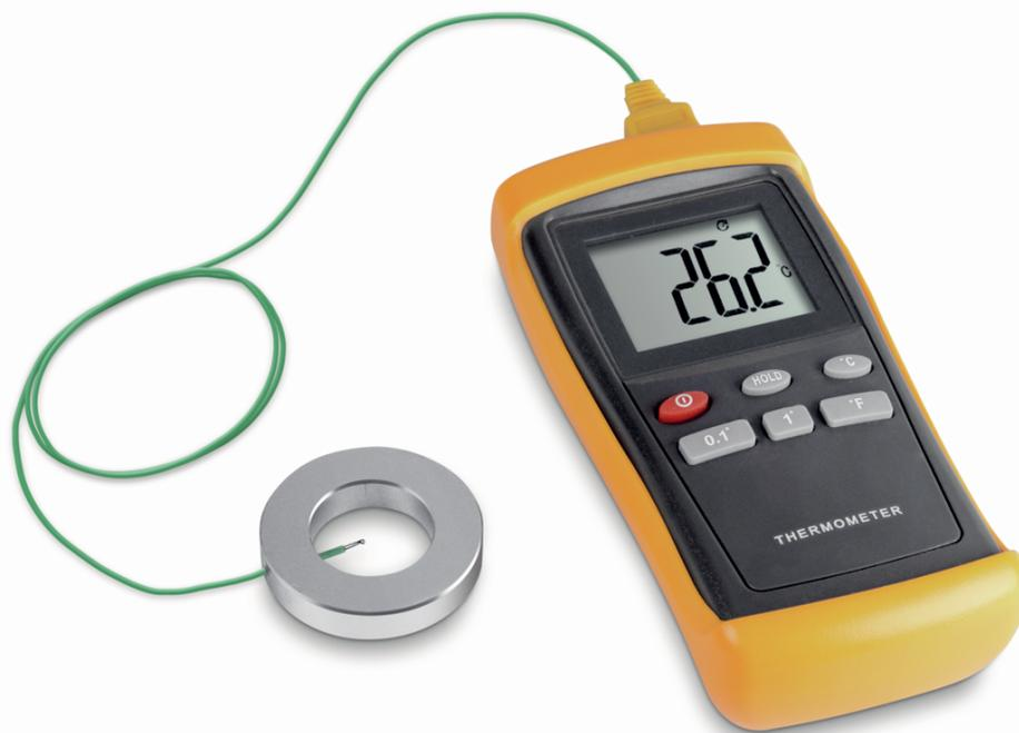
Set calibrazione temperatura composto da indicatore e sensore
