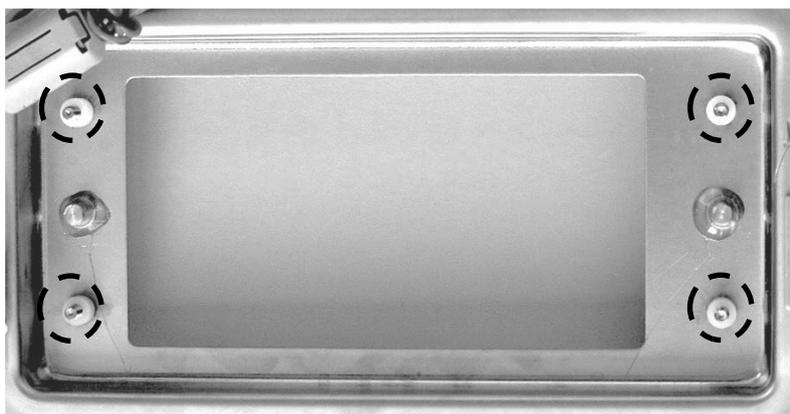
7. Montar la salida de relé con los orificios de los pernos roscados.
