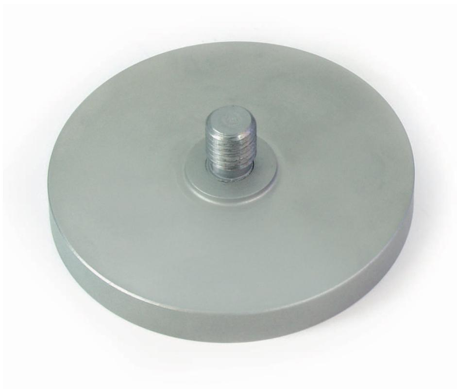
Plaque de compression d'aluminium, épaisseur 10 mm, pour essais de compression jusqu'à 5 kN, diam. 110 mm, filetage extérieur : M12
