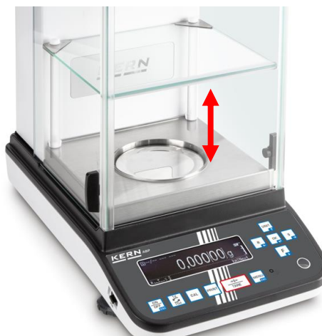
Fig. 2 Det invändiga vindskyddet med korta stöd och plåtskydd
