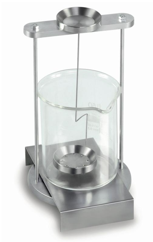
Jeu de détermination de la densité des matières liquides et solides avec une densité  $\rho = 1$
