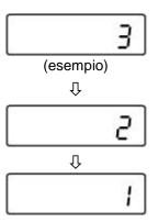
Nel frattempo la bilancia registra alcuni valori di misura. Allo scadere del tempo predefinito sarà visualizzato il valore di pesatura.
