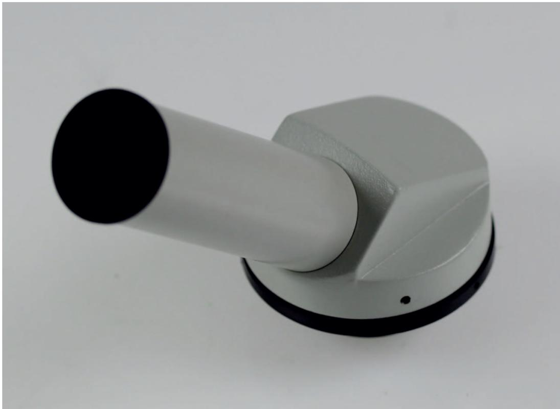
Tubus Monokular, 45° geneigt, 360° drehbar
