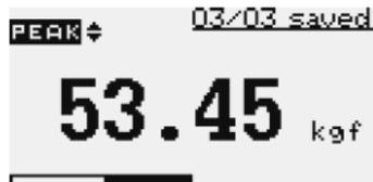
Mit den Pfeiltasten UP und DOWN kann innerhalb des Speichers die Seite gewechselt werden und indem eine dieser beiden Tasten gedrückt und gehalten wird, kann nach oben oder unten gescrollt werden.
