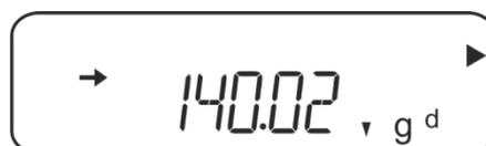
4. La indicación "wAtr" permanecerá en la pantalla durante aproximadamente 2 s. La indicación cambia automáticamente a [0.00 ▼ g d]. Sacar la muestra del plato superior y, si necesario, tarar la balanza.
