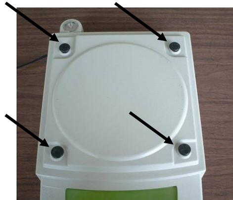
4. Colocar el soporte de sujeción del platillo de la balanza en las cuatro fijaciones, como se indica en la imagen. Asegurarse que la posición sea correcta. Las aperturas de la parte superior han de estar dirigidas hacia el frente.
