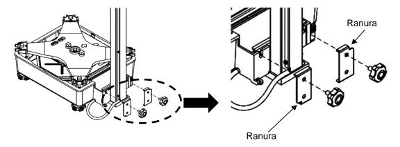
11. Enrolle sin apretar el exceso de cable de la balanza [5] y colóquelo en el interior de la bandeja de cable.
