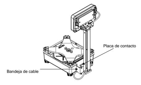
8. Pase el cable de la balanza [5] a través de la ranura inferior en el soporte [2].
