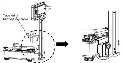
13. Inserte desde arriba la cubierta de las perillas por encima de las dos perillas de la fijación a la pared. La ranura en la fijación a la pared asegura su bloqueo.
