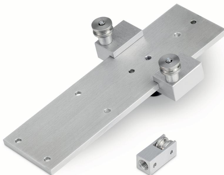
Supporto per tensiometro con funzione di inserimento sicuro: L'inserimento del filo da misurare nei rulli di guida avviene tramite trarre e mollare del filo stesso, per la misurazione della tensione di trazione fino a 250 N, Supporto in alluminio, rulli regolabili verso l'interno
