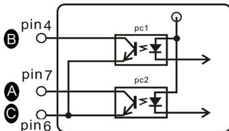
Los pines 6 y 7 se conectan después de la activación de la alarma de sobrecarga. En el modo de ajuste, los pines 6 y 7 se conectan después de superar el valor límite superior, y los pines 4 a 6 - después de no alcanzar el valor límite inferior.
