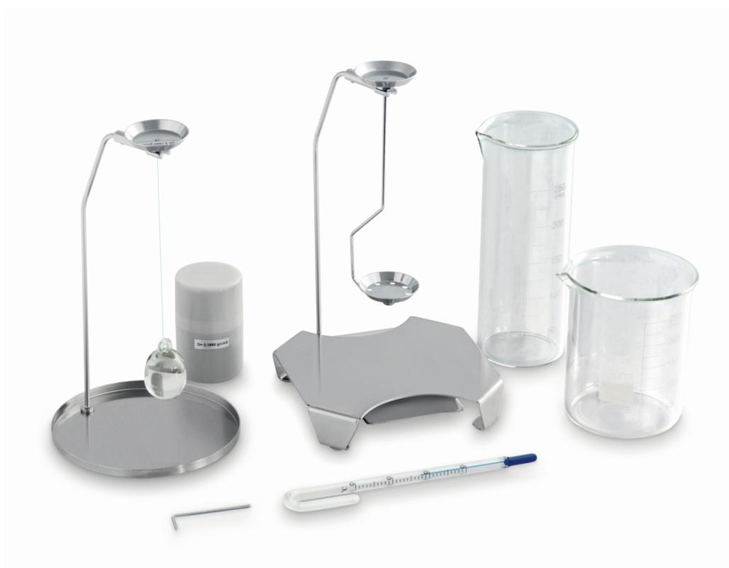
Set per la determinazione di densità di liquidi e solidi con densità  $\neq 1$ , solo per modelli con lettura  $[d] = 0,001 \text{ g}$
