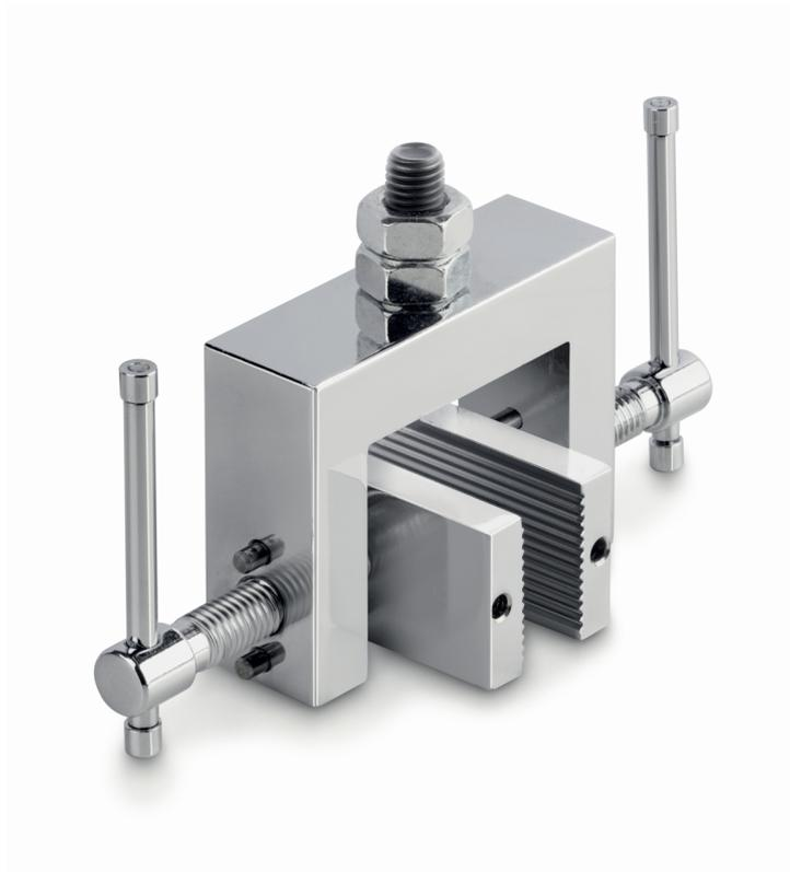
2-Breitbacken-Schraubspannklemme für Zug- und Abzugstests
