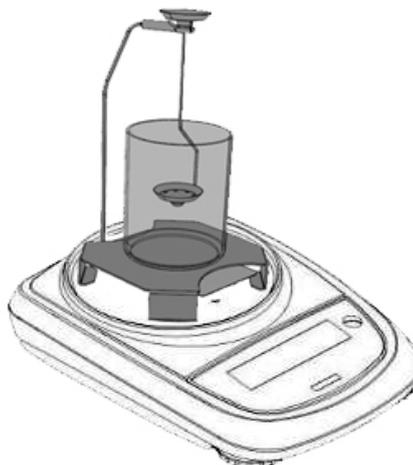
Kit de densité installé pour matériau solide „Balances d'analyse“
