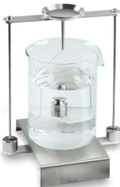
Obr. 2: „Vážení ve zkoušené kapalině“
