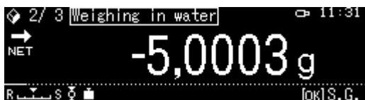
Obr. 4: Vážení v pomocné kapalině
