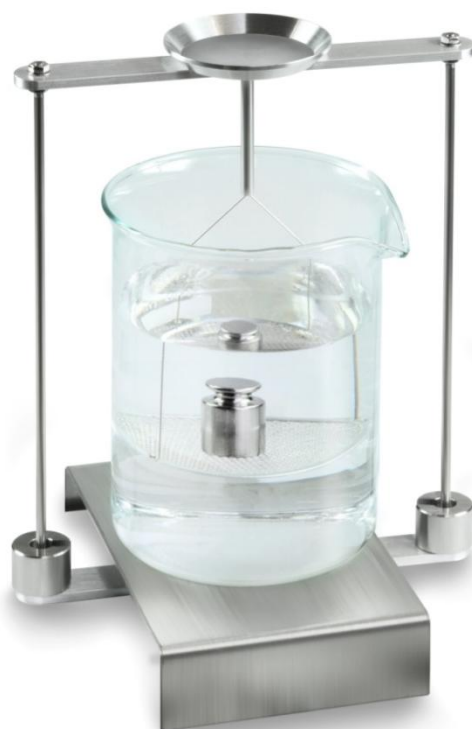
Obr. 2: Vážení v pomocné kapalině
