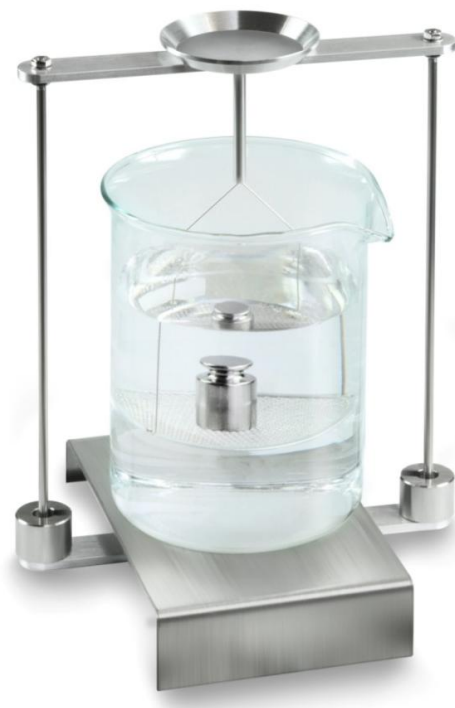
Obr. 6: Vážení ve zkušební kapalině
