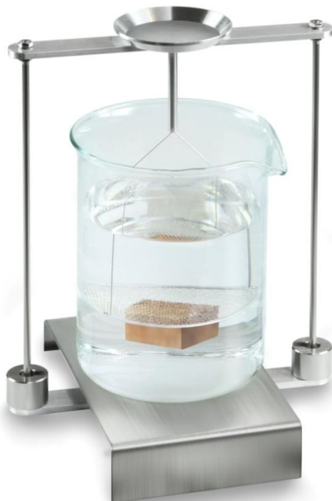
Obr. 4: Vážení v pomocné kapalině
