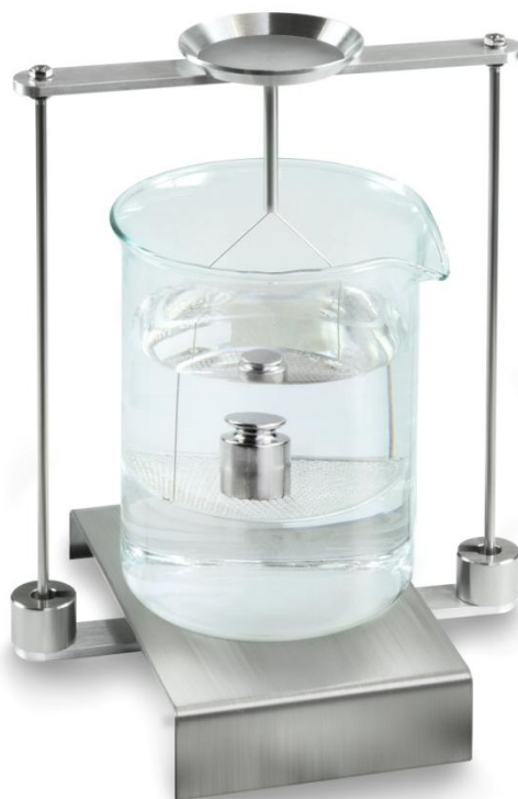
Obr. 2: Vážení ve zkoumané kapalině
