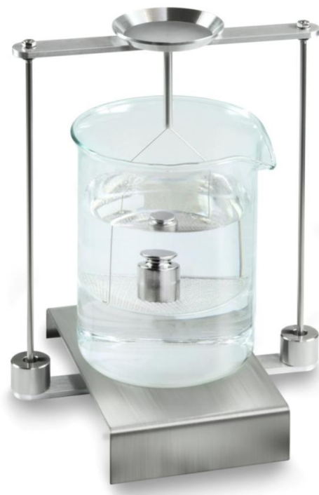
Obr. 6: Vážení ve zkušební kapalině
