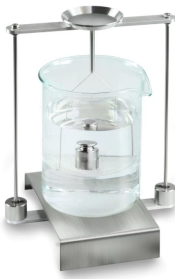
Obr. 2: „Vážení v pomocné kapalině“
