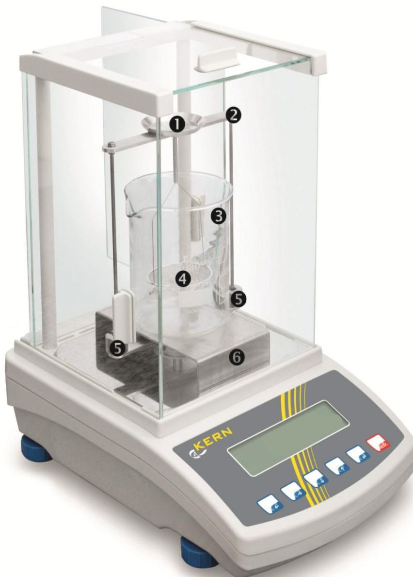
Vzorový obrázek váhy s nainstalovanou sadou pro stanovení hustoty KERN YDB-03
