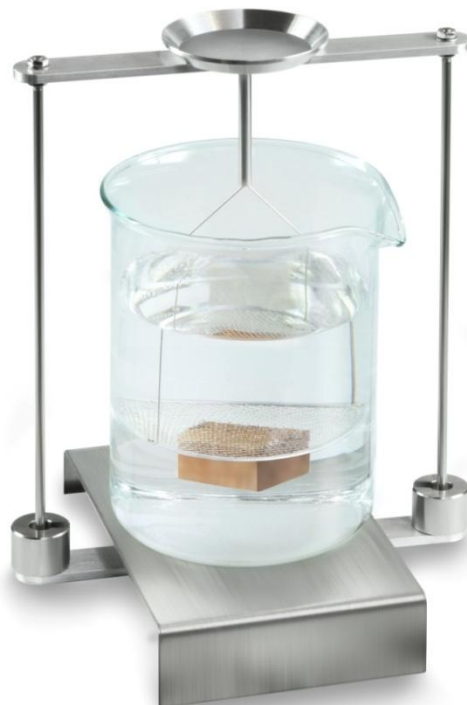
Obr. 4: Vážení v pomocné kapalině
