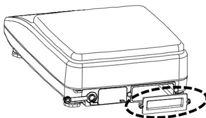
2. Inserire le pile/batterie nel porta batterie: 1,5 V, tipo AAA, 4 pz.
