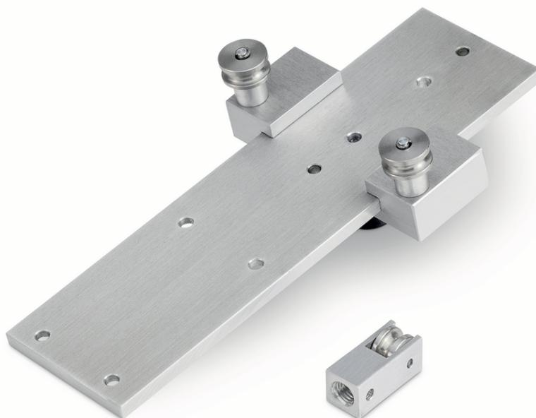
Elemento sobrepuesto para tensiómetro con función “safe-insert”: Tirar y soltar para introducir el cable en cuestión en las poleas de guía, para comprobaciones de tensionado hasta 250 N, elemento sobrepuesto de aluminio, ruedas graduables hacia dentro
