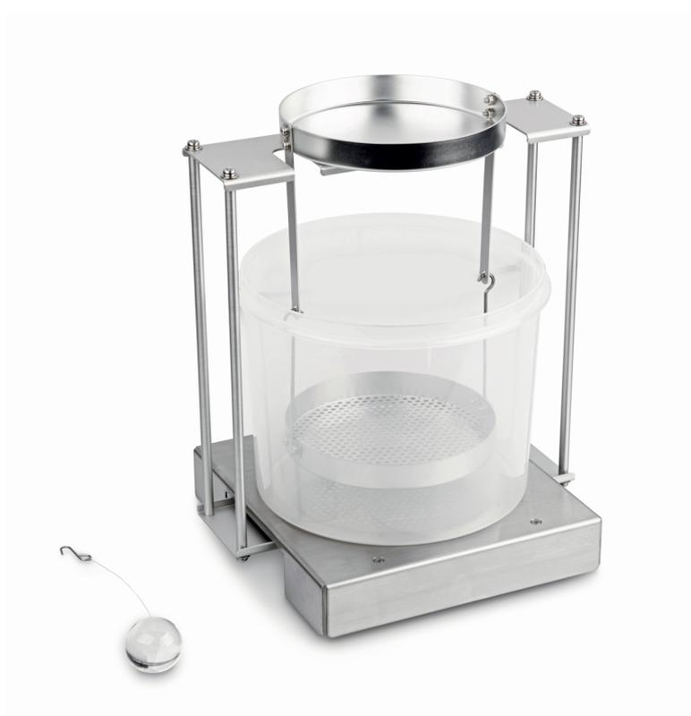
Kit de détermination de la densité, de série, possibilité d'équipement ultérieur
