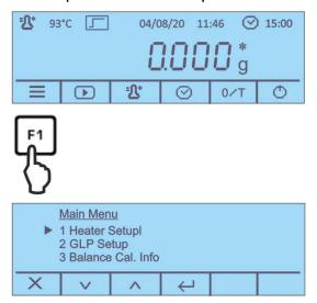
2. Use los botones para seleccionar el elemento de menú <7 – Heater Calibration> y confirme mediante el botón
