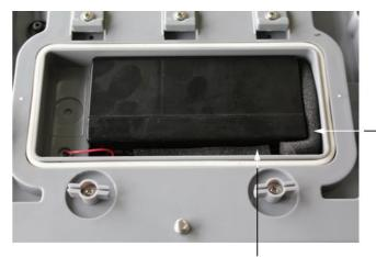
⇒ Colocar la batería de modo que no se mueva (bloquearla con el bloque de espuma).
