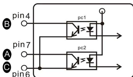
I pin 6 e 7 sono attivati dopo l'attivazione dell'allarme di sovraccarico.
