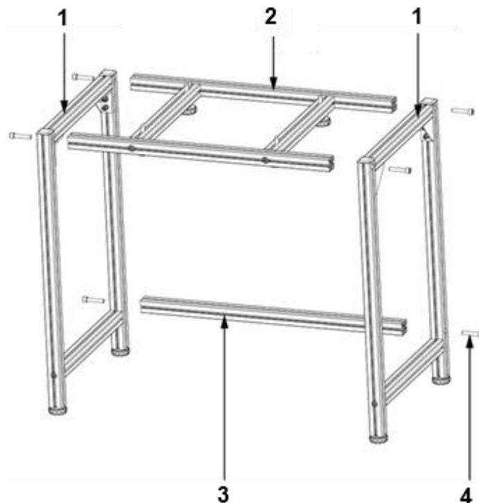
2. Coloque y sujete los paneles laterales interiores (1) derecho e izquierdo.
