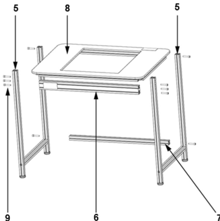
9. Coloque y sujete los paneles laterales exteriores (5) derecho e izquierdo.
