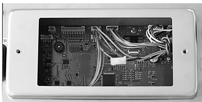
3. Svitare con cautela la parte posteriore dell'alloggiamento del terminale dalla parte anteriore dell'alloggiamento.
