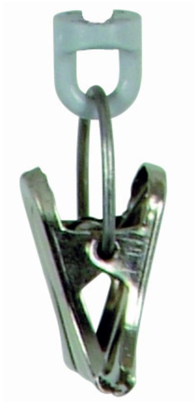
Pinza para balanza mecánica &lt; 2500 g
