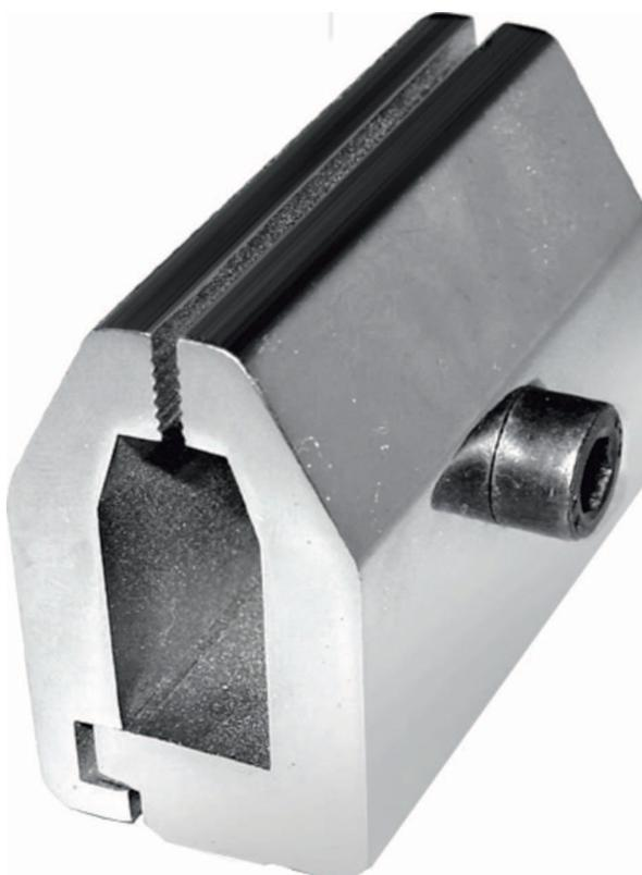
Morsetto a vite per prove di trazione
