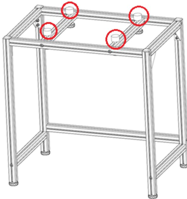
6. Fixer les 4 blocs de caoutchouc.
