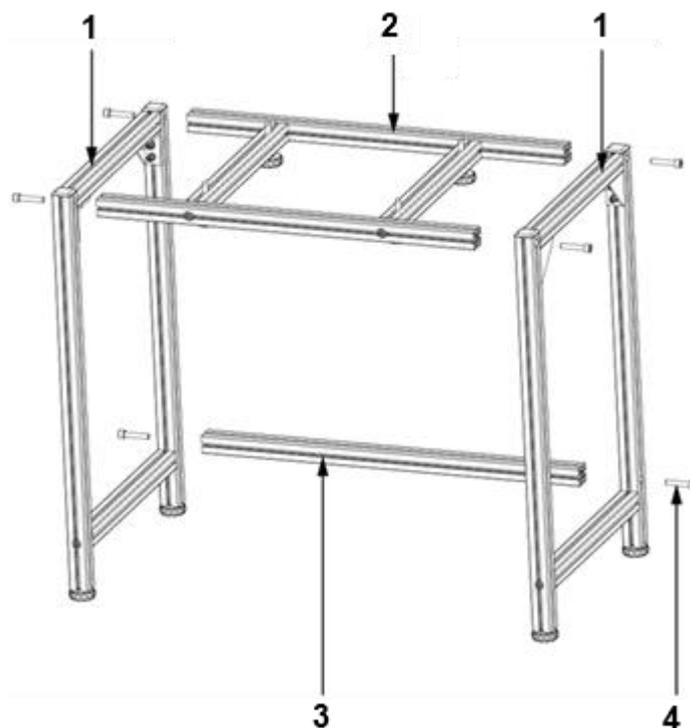
2. Positionner les parties latérales intérieures (1) à droite et à gauche et les maintenir en place.
